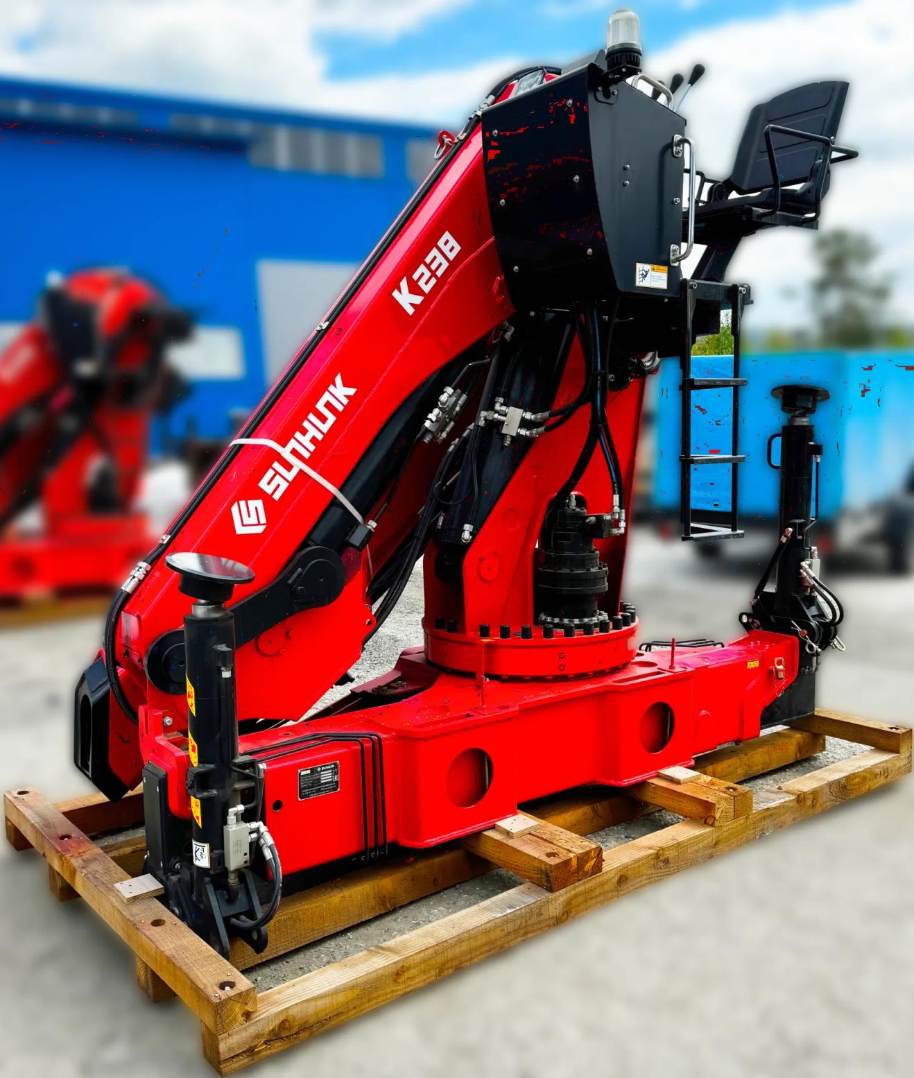
Кран-манипулятор модели Sunhunk K 238-6 применяется для выполнения различных погрузочно-разгрузочных манипуляций и осуществления строительно-монтажных мероприятий. Эта шарнирно-сочлененная установка, произведенная в Китае, характеризуется следующими техническими показателями: грузоподъемность данной модели составляет 10 тонн при минимальной длине вылета стрелы 2 метра и достигает 1,75 тонны при максимальной длине вылета в 12,54 метра.
