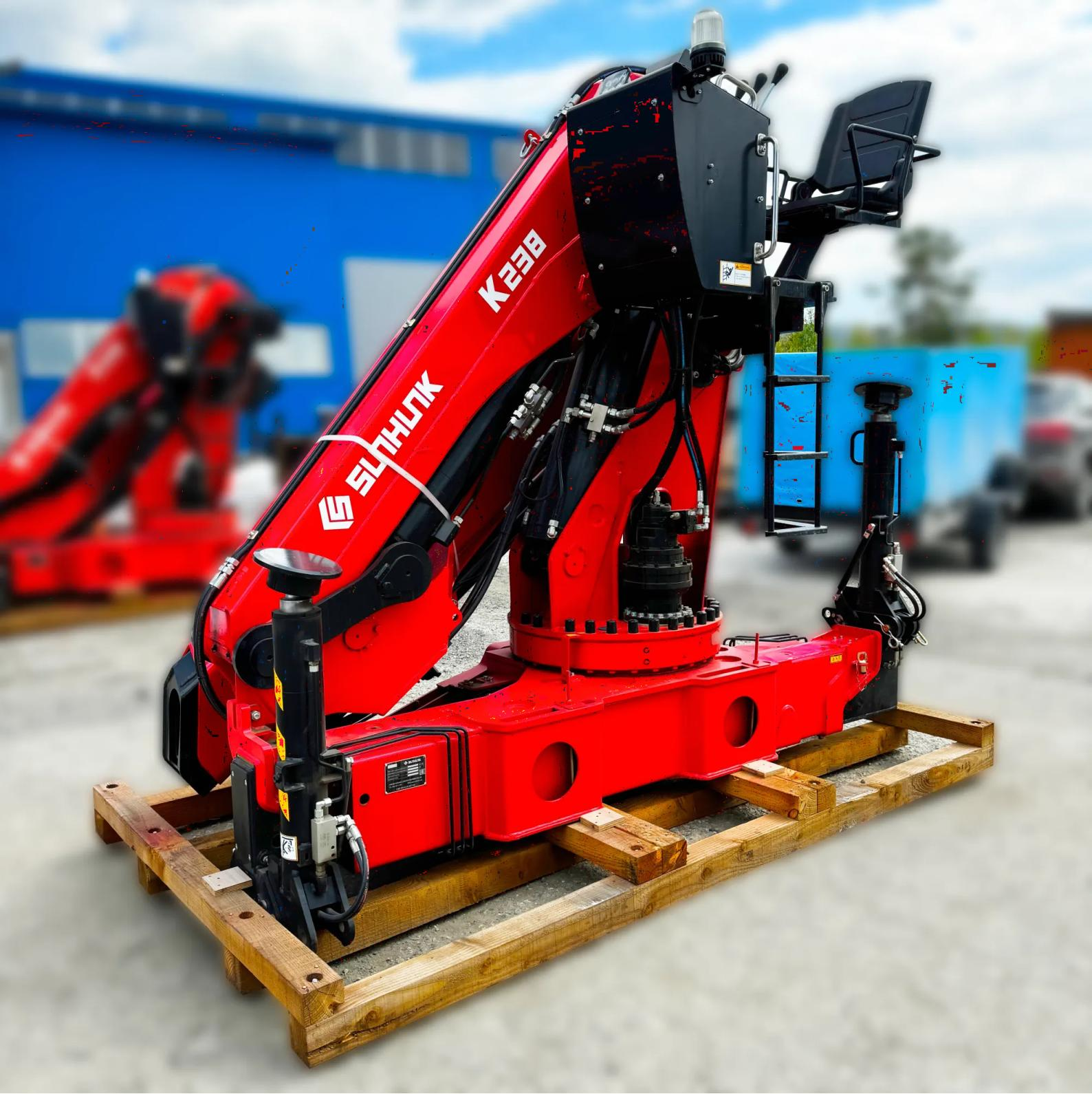
Кран-манипулятор модели Sunhunk K 238-6 применяется для выполнения различных погрузочно-разгрузочных манипуляций и осуществления строительно-монтажных мероприятий. Эта шарнирно-сочлененная установка, произведенная в Китае, характеризуется следующими техническими показателями: грузоподъемность данной модели составляет 10 тонн при минимальной длине вылета стрелы 2 метра и достигает 1,75 тонны при максимальной длине вылета в 12,54 метра.
