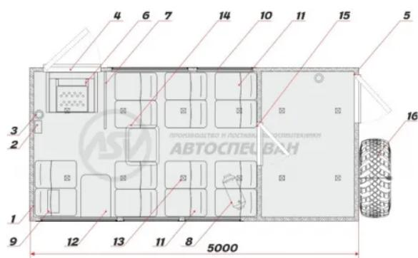
Кузов-фургон изотермический  $S=60$  мм ;
